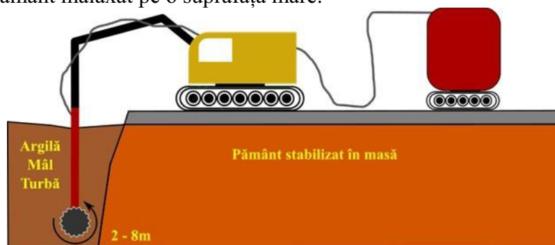
Figura 41. Tehnica de stabilizare în masă pe cale uscată (Briancon et al., 2018)
