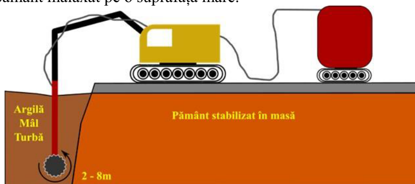
Figura 34. Tehnica de stabilizare în masă pe cale uscată (Briancon et al., 2018)
