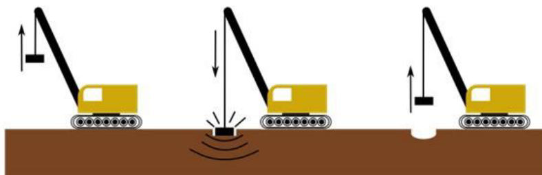
Figura 2. Principiul compactării dinamice (Briancon et al., 2018)
